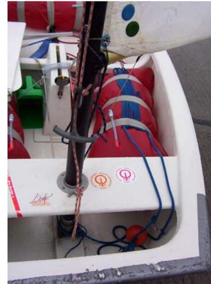
Damit die Schleppleine immer sofort einsatzbereit ist, sollte sie nicht einfach unter die Mastducht geworfen werden, wo sie sich leicht verknoten kann. Man kann die Schleppleine in langen geordneten Bahnen unter die Gurte eines seitlichen Auftriebskörpers legen.
